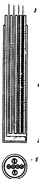
Рис. 1. Ячейка из окиси бериллия для измерения электропроводности селена при высоких температурах: 1 — круглый канал, в котором содержится жидкий селен, просверленный в теле стержня из \text{BeO} , 2 — стержень из окиси бериллия, 3 — два токовых и два потенциальных графитовых электрода, 4 — стакан из \text{BeO} , 5 — два канала, в которые вставляются термодпары ВР5—ВР-20 для измерения температуры
