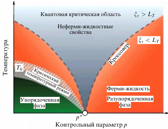
Рис. 10. (В цвете онлайн.) Фазовая диаграмма вблизи квантовой критической точки. Неферми-жидкостное поведение времени релаксации и сопротивления может наблюдаться в квантовой критической области, где \xi_\tau > L_T = \hbar/(k_B T) , что соответствует \hbar\Omega_0 < k_B T .
